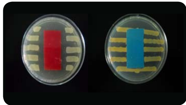
图2 采用AATCC 147-2004 标准测试出现的有抑菌区（左）和无抑菌区（右）
